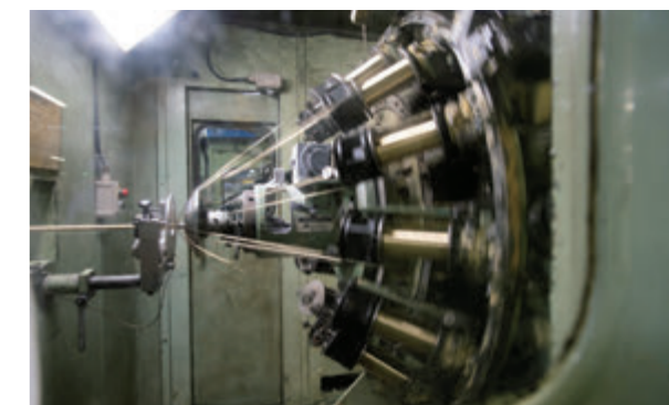
Wires and cords are wrapped around plain rubber hoses for reinforcement. プレーンなゴムホースの周りに、ワイヤーや糸を巻き付けて補強する。
